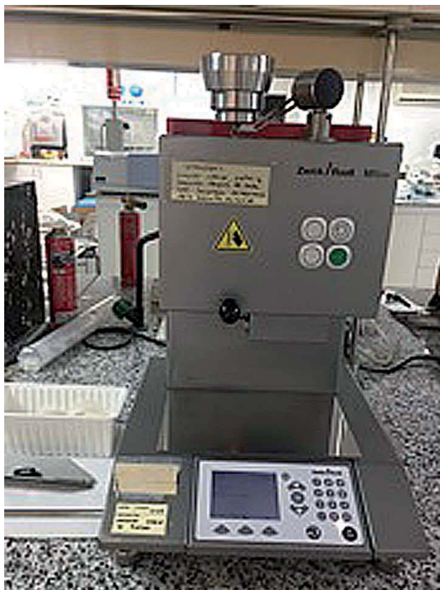
Figura 7: Plastómetro para determinación del índice de fluidez
