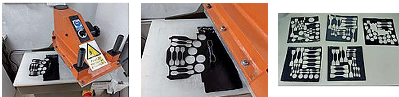
Figura 3: Troquelado de las probetas de ensayo a partir de láminas moldeadas
