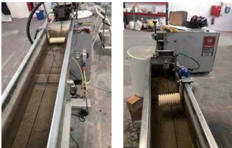
Figura 23: Extruido y granceado del las mezclas
