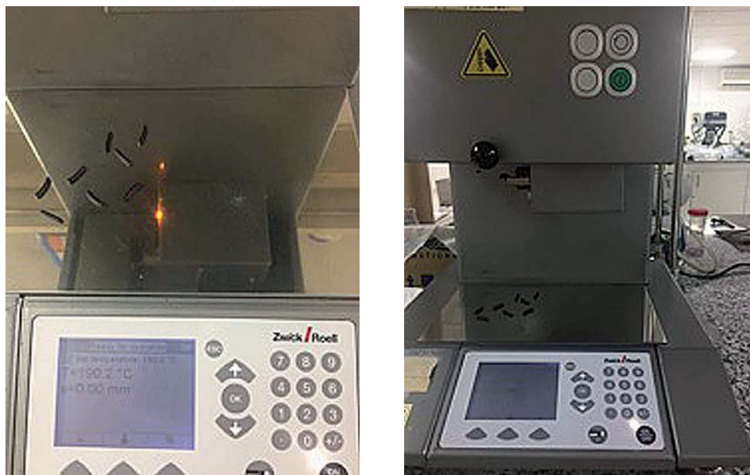
Figura 8: Extruidos cortados durante el ensayo IMF
