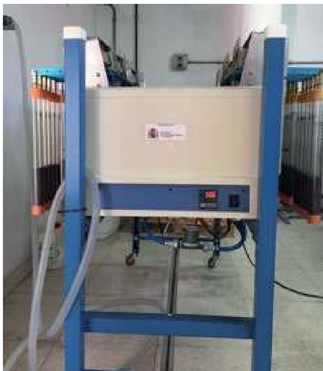
Figura 11: Equipo para la determinación de la resistencia al stress cracking con baño termostático
