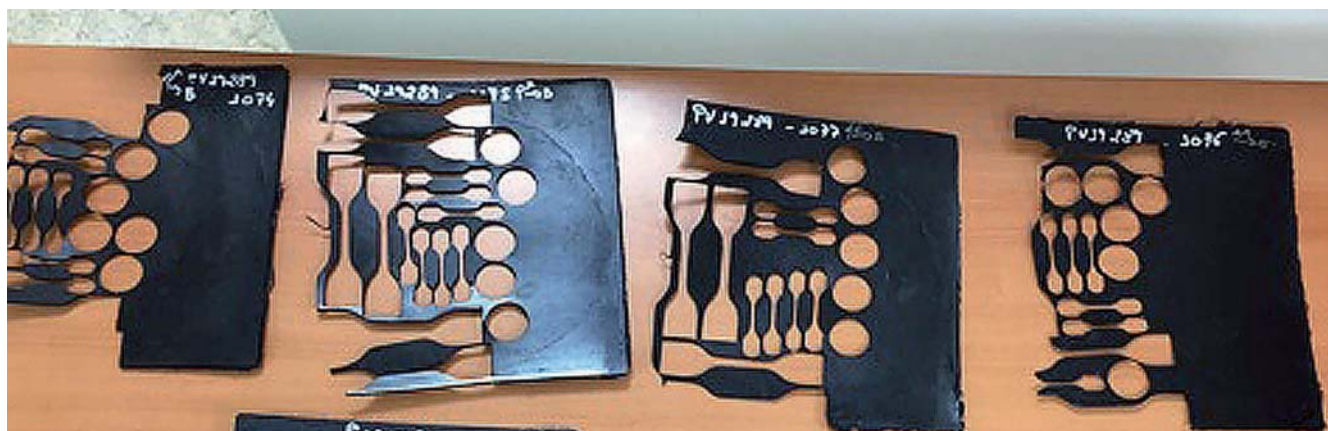
Figura 25: Planchas de mezclas con material reciclado
