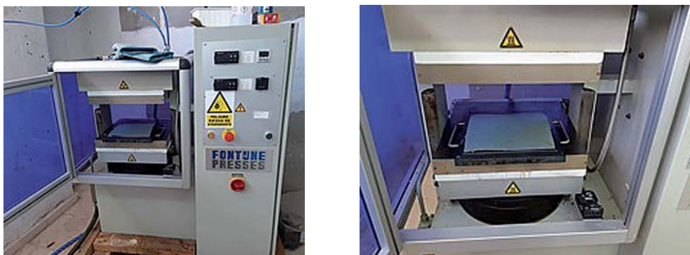
Figura 2: Moldeo de placas de material para ensayo
