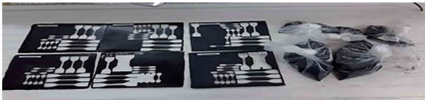
Figura 33: Planchas de material con reciclado tras extrusión reactiva
