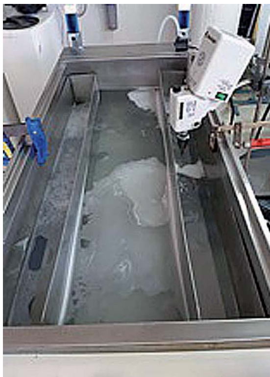
Figura 10: Baño termostataado para ensayo ESCR
