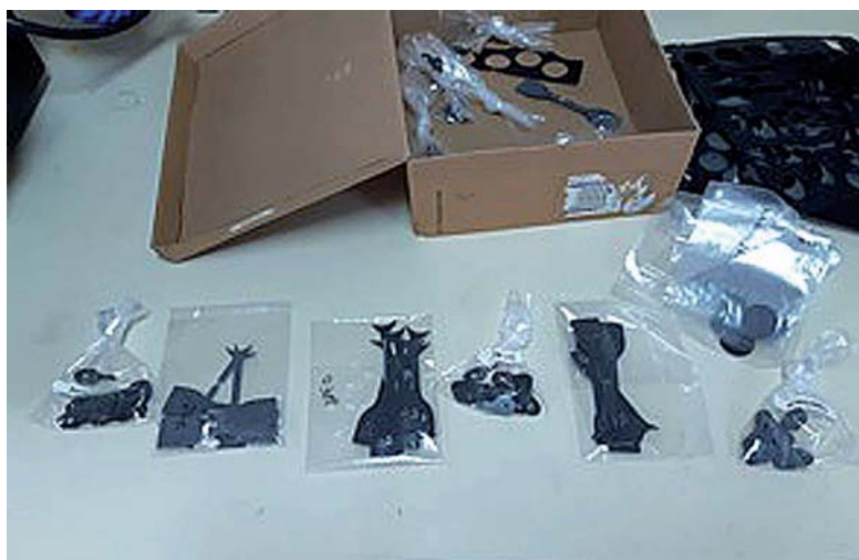
Figura 4: Probetas de ensayo troqueladas de las placas moldeadas
