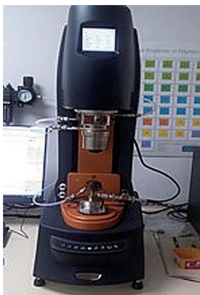
Figura 5: Reómetro rotacional de platos paralelos con muestra de ensayo
