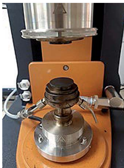
Figura 5: Reómetro rotacional de platos paralelos con muestra de ensayo
