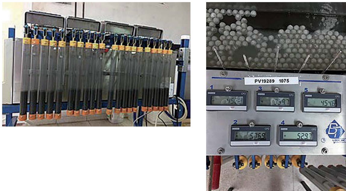
Figura 13: Aplicación de peso longitudinal sobre las probetas sumergidas en tensoactivo. Temporizadores de registro de tiempo de rotura de las probetas.
